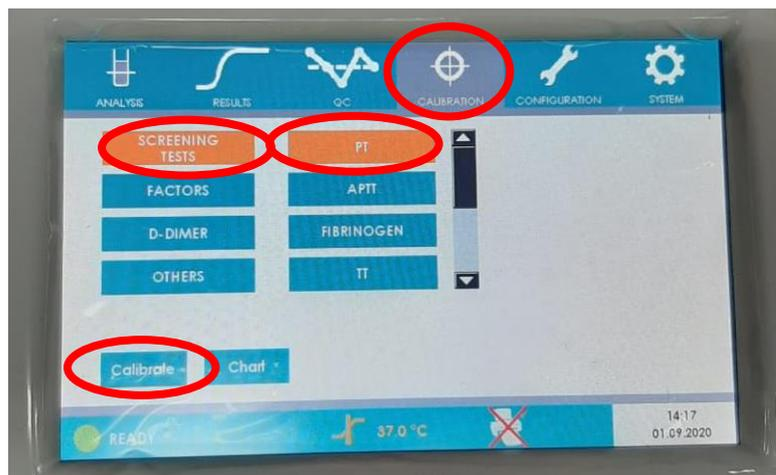
6. A tela seguinte se abrirá. Na parte superior, preencha com os dados do reagente. Na parte inferior, preencha com os dados do calibrador (se utilizar pool de amostras, inserir um lote imaginário);
