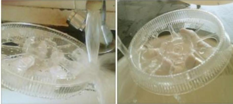
5. Mergulhe o rotor em solução de ácido nítrico a 3% ou ácido clorídrico e mantenha-o por 5 minutos (caso seja necessária a desproteinização).
