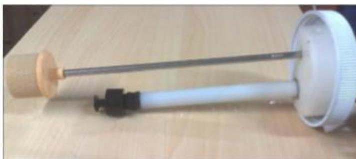
*Figura 8 Sensor de Nível para Água DI*
