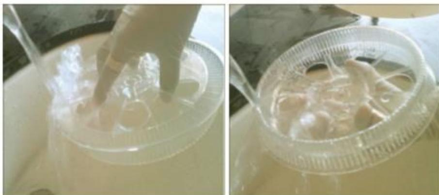
7. Mergulhe o rotor em água destilada e mantenha-o por 30 minutos.
